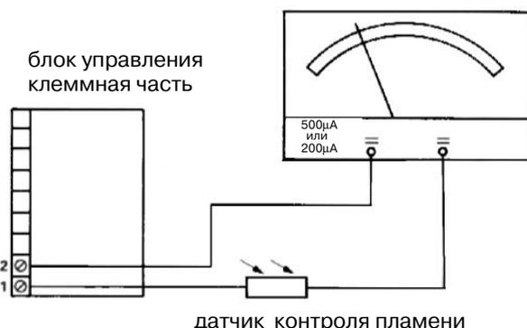
Для измерения фототока снимается штекерная часть реле контроля пламени и между штекером и разъемом устанавливается измерительная кабельная пара. Оба измерительных ввода подключаются к измерительному прибору. При отрицательном отклонении стрелки измерительного прибора следует поменять полярность штекеров измерительной линии! Прибор устанавливается на измерение постоянного тока, диапазон измерения прим. до 200 µA!
